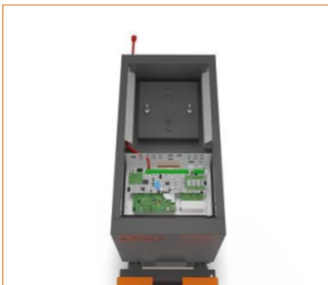
Das Displaykabel mit einem kleinen Schraubendreher trennen.
