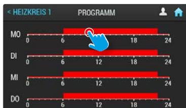
Der Regler ermöglicht die Arbeit von Kessel, Heizkreis und Warmwasser nach den vorgegebenen 24-Stunden-Programmen separat für jeden Wochentag.
