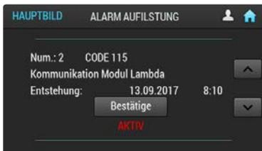
Das Steuergerät verfügt über einen Verlauf von Alarmen, der gespeichert wird. Sollten aktive bzw. nicht quitierte Alarme auf dem Hauptbildschirm auftreten, erscheint das Alarmzeichen. Nachdem Sie das Zeichen gedrückt haben wird der Verlauf angezeigt. Im Verlauf werden die 20 letzten Alarme gespeichert.
