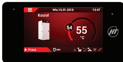
Die Wetterfunktion des Reglers ermöglicht die automatische Umschaltung der Betriebsart des Kessels: WINTER - SOMMER.
