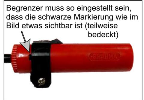
Fotozelle vorsichtig in den Flansch bis zum Begrenzer setzen (muss klicken)
