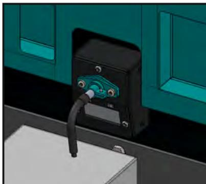
Fotozelle vorsichtig in den Flansch bis zum Begrenzer setzen (muss klicken)
