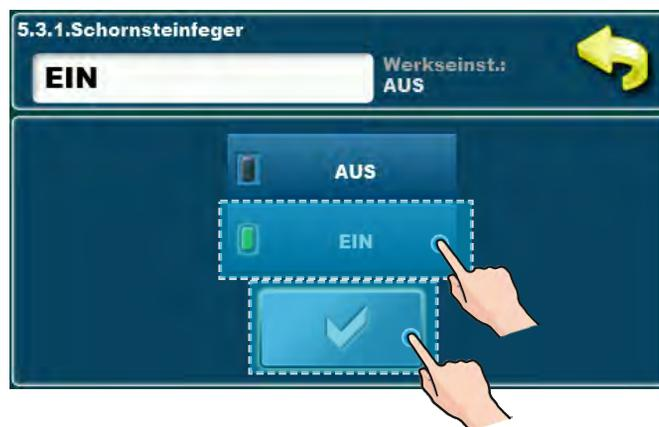
Wenn diese Option aktiviert ist, wird die Taste "BETRIEB STATUS" zur "SCHORNSTEINFEGER" Taste (1) gewechselt, und mit drück auf sie, wir betreten das Menü "SCHORNSTEINFEGER" direkt (ohne dass Sie durch die Menüs scollen müssen). In diesem Menü können wir auf die Parameter des "SCHORNSTEINFEGER" Menüs zugreifen und diese ändern.
