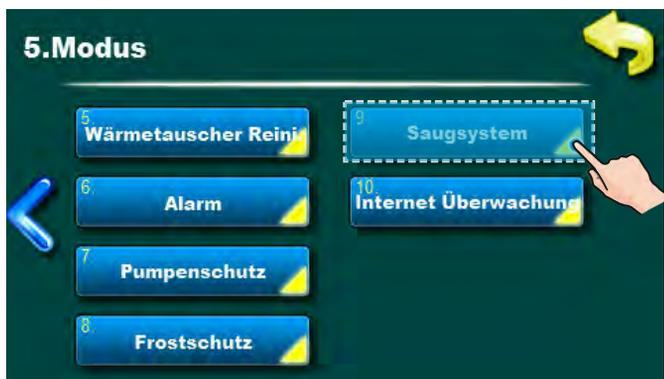
Diese Option wird zum Einstellen des Pellet-Vakuumsförderungs verwendet.
