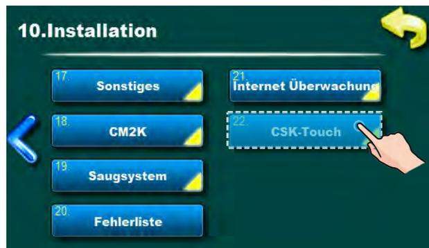
Nach der Konfiguration der Heizkreise am CM2K-Modul, ist im CSK-Touch Menü das Menü „INFO“ zu öffnen und die CSK-Touch WiFi ID (1) und Adresscodes (2) (je nach Anzahl der eingebauten Korrektoren), die dann bei der Konfiguration in jedem CSK-Touch eingetragen werden muss.
