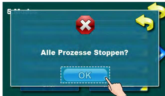
**WICHTIG!** Um alle Prozesse zu beenden, muss der Kessel erst mit ON/OFF Taste
