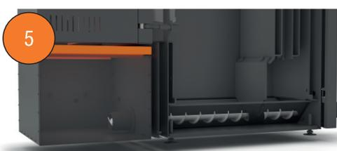
Die automatische Ascheentfernung transportiert die Asche vom Kessel in einen externen Behälter. Die Asche wird im Behälter so verdichtet, damit so viel wie möglich darin hineinpasst. Das Intervall der Ascheentfernung wird somit auf mehrere Monate verlängert, bevor der Außenbehälter gefüllt ist, der dann leicht vom Kessel getrennt und entleert werden kann.
