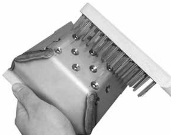
Beispiel: Reinigung der Brennkammer
